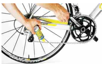
Fig 3.18 (d) Lubricating the bicycle chain
